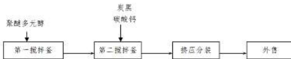
图 2-1 无溶剂密封胶、水性粘合剂生产工艺流程简图
