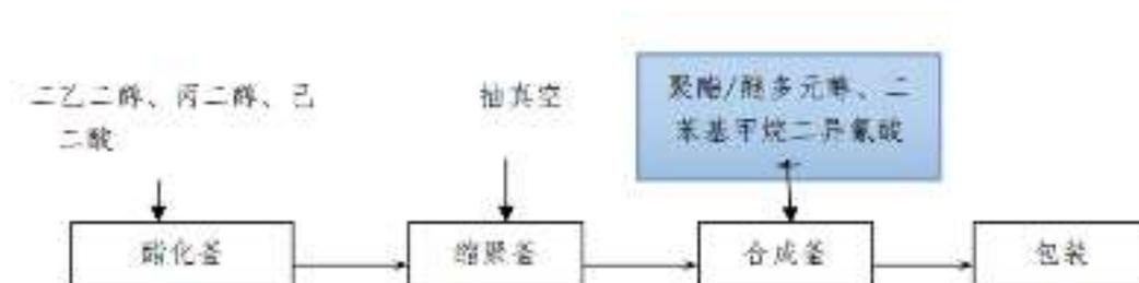
图 2-2 无溶剂粘合剂生产工艺流程图
