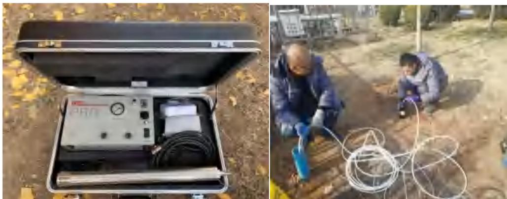
地下水装入样品瓶后，记录样品编码、采样日期和采样人员等信息，贴到样品瓶上。地下水采集完成后，样品瓶应用泡沫塑料袋包裹，并立即放入现场装有冷冻蓝冰的样品箱内保存。根据地下水平行样采集要求，本次采样平行样占比为 20%。
